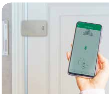
Bloqueo y desbloqueo de la cerradura desde el teléfono móvil.
